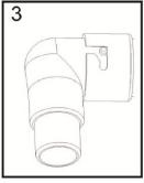
Appuyer sur l'adaptateur pour qu'il soit en contact avec la pièce d'extrémité
