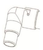
Petit adaptateur : Utiliser le joint torique. Tourner jusqu'à ce que l'adaptateur soit fixé fermement
